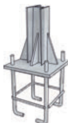
Cimentación placa anclaje
