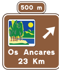
Preseñalización de salida en carretera convencional
